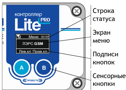
Рисунок 5. Дисплей контроллера LitePro
